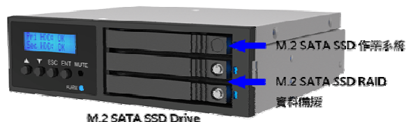
(1) 2.5" M.2 SATA SSD 作業系統 + M.2 SATA SSD RAID 資料備援
